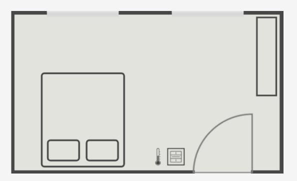
Exemple dans une chambre à coucher ou l'on souhaite régler la température du chauffage au sol.
